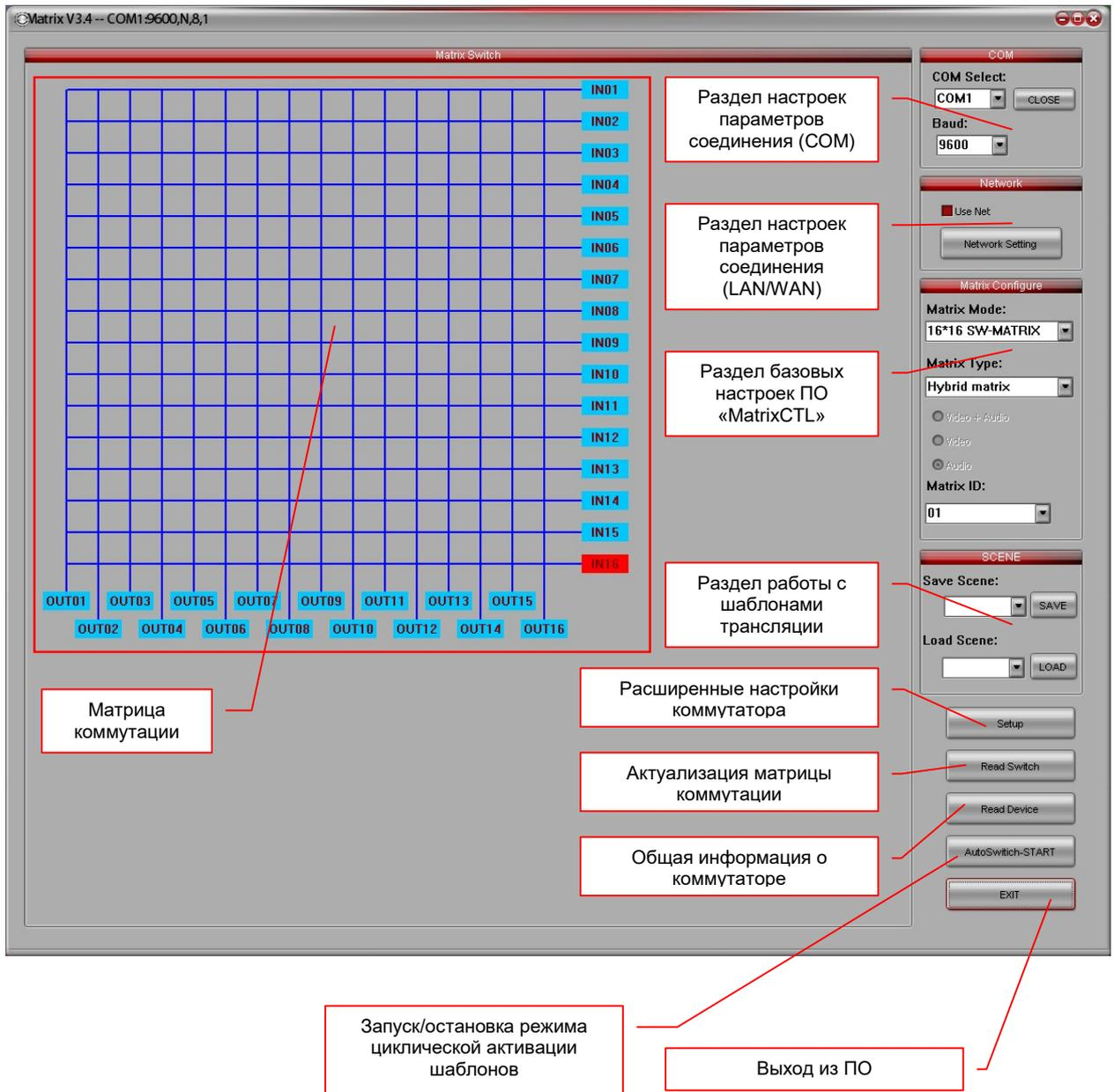
После запуска, ПО автоматически пытается установить связь с коммутатором, используя для этого установленные в нем параметры соединения (RS232 или LAN). При первом запуске ПО, установлены следующие параметры соединения: **COM-порт №1, скорость соединения – 9600 бит/с, ID-коммутатора – 1.**
