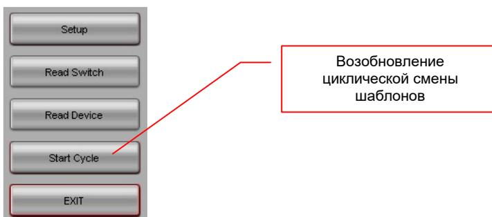
После нажатия кнопки «**Start Cycle**», коммутатор продолжит остановленный цикл, начиная с шаблона, который участвует в цикле и идет следующим по номеру за шаблоном, на котором цикл был остановлен. При этом не важно, активировался или нет какой либо шаблон в промежутке времени, с момента остановки цикла до момента его возобновления или была произведена произвольная коммутация портов, цикл продолжится с указанного выше шаблона.
