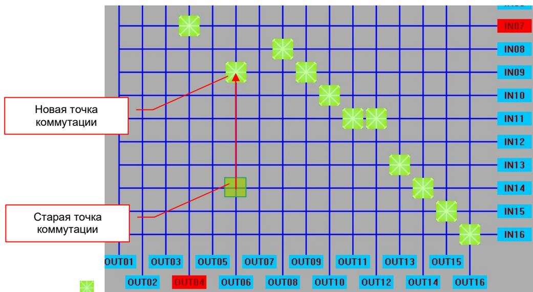
К одному входному порту, в один момент времени, могут подключиться все выходные порты коммутатора, но при этом, выходной порт, в один момент времени может быть подключен только к одному входному порту.
