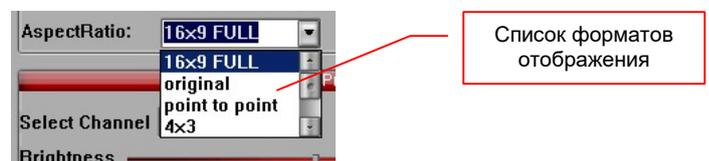
Работает функция следующим образом, сначала формируется «пустое» изображение с разрешением, которое установлено на скоммутированном выходном порту. Если скоммутированных выходных портов несколько и они имеют разные разрешения, то для каждого выходного порта формируется свое «пустое» изображение. После этого, на пустое изображение накладывается картинка от источника сигнала, согласно выбранному формату отображения.
