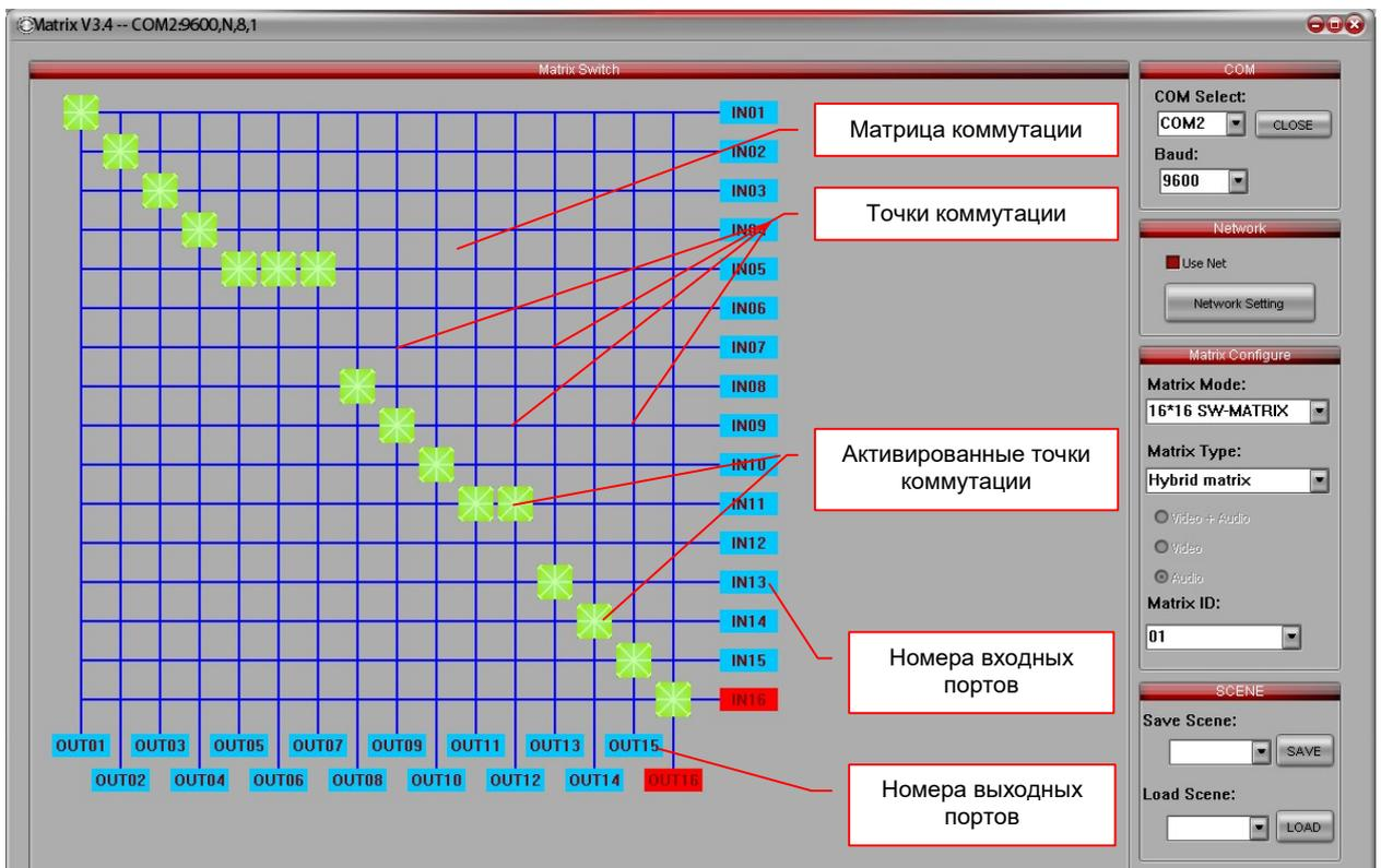
Матрица коммутации всегда отображает свое актуальное состояние. Даже если происходит коммутация сигналов не при помощи ПО, а например, при помощи сенсорного экрана коммутатора или команд API (команды внешнего управления коммутатором). Как только происходит коммутация, на матрице тут же отображается это
