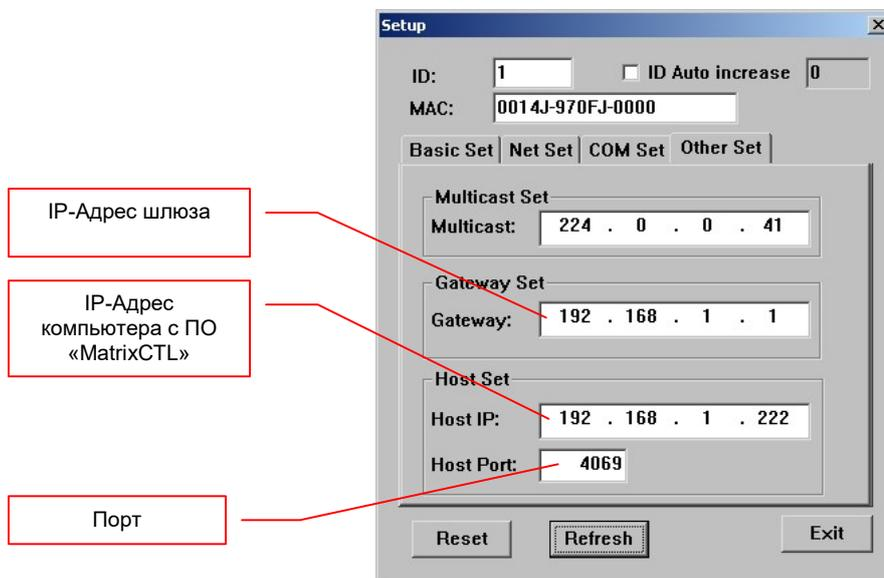
IP-адрес шлюза задается в поле «**Gateway**», IP-адрес компьютера в поле «**Host IP**», номер порта в поле «**Host Port**».
