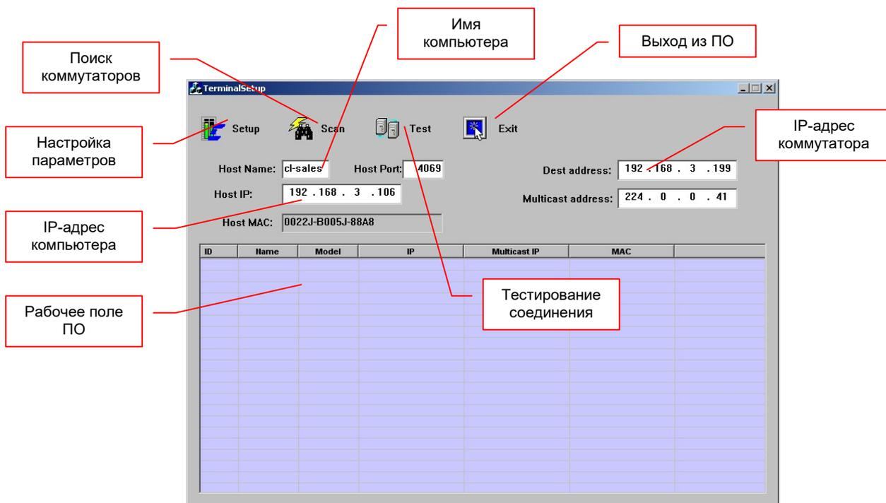
Для поиска коммутаторов нажмите кнопку «Scan». Через некоторое время ПО отобразит в рабочем поле список доступных для настроек коммутаторов и их текущие параметры.
