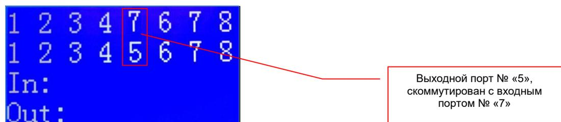
Коммутатор всегда отображает реальное текущее состояние коммутации. Как только происходит переключение, это моментально отображается на экране.
