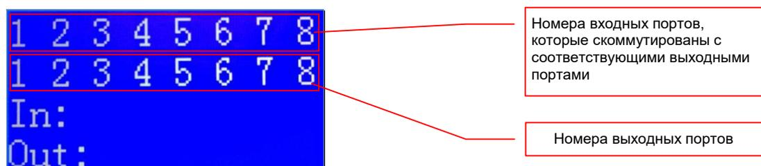
По умолчанию, экран работает в **базовом режиме отображения**, который информирует о текущем состоянии коммутации. Нижний ряд цифр соответствует номерам выходных портов, а верхний ряд цифр, соответствует номерам портов, которые скомутированы с соответствующими выходными портами. Например, если выходной порт № «5» скомутирован с входным портом № «7», то над цифрой «5» в нижнем ряду, будет стоять цифра «7».
