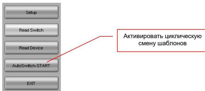
После нажатия на кнопку «**AutoSwitch-START**», коммутатор, в зависимости от текущего состояния матрицы коммутации активирует шаблон:
