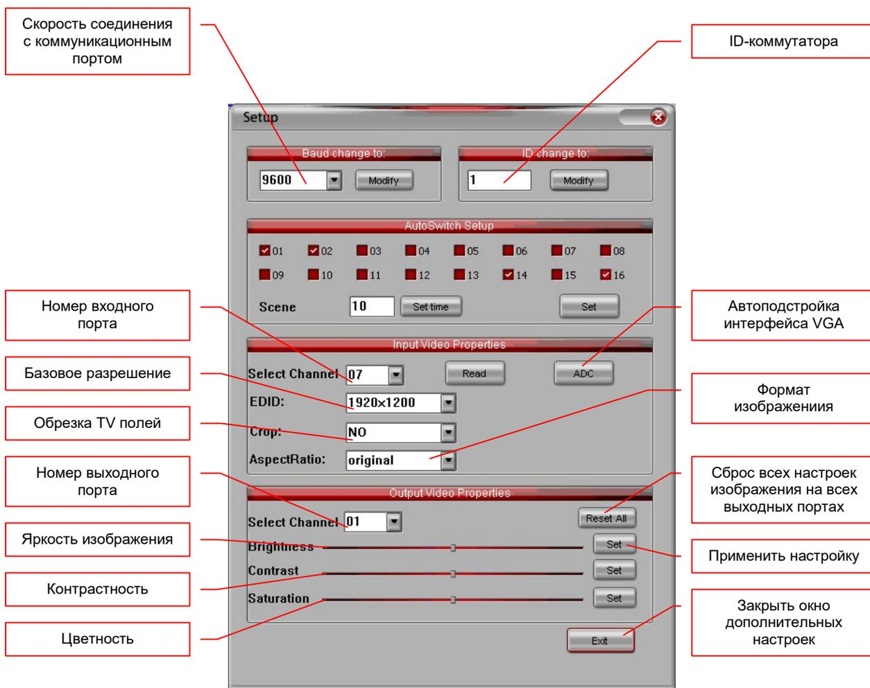
Для закрытия окна дополнительных настроек коммутатора необходимо нажать кнопку «Exit».
