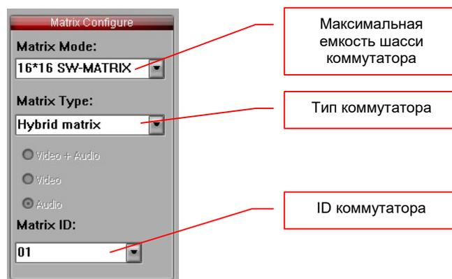
«**Matrix Mode**» — Поле задает значение максимального размера матрицы коммутации, которая будет доступна для работы в ПО. Поле может принимать следующие значения:
