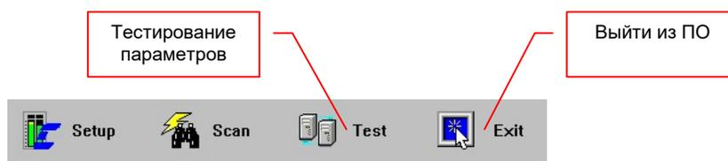
Если параметры настроены некорректно, то такие коммутаторы, после нажатия кнопки «**Test**» из списка исчезнут. Для исправления настроек, необходимо нажать кнопку «**Scan**» и повторить необходимые действия по настройке коммутаторов.
