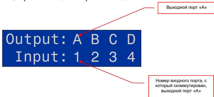
**Для информации!** Если с коммутатором не производят никаких действий в течение установленного времени, то у него автоматически выключается ЖК-дисплей. Дисплей автоматически включается при подаче команд коммутатору (посредством кнопок на лицевой панели, пульта ДУ, команд 232). Процедура настройки времени отключения ЖК-дисплея, будет описана ниже.
