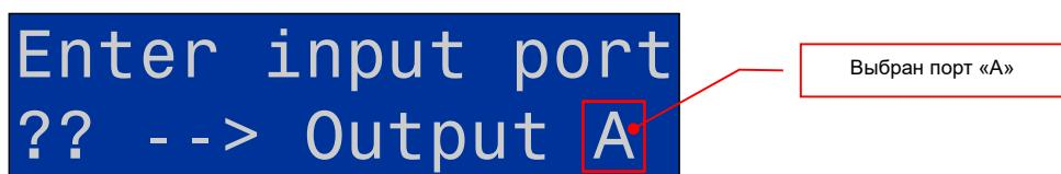
Нажатием кнопки «1», «2», «3» или «4» выберите соответствующий номер входного порта, с нужным источником сигнала. Коммутатор произведет переключение, с отображением результата произведенной коммутации на жк-дисплее.
