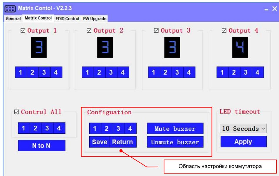
**Для активации шаблона трансляции нажмите на кнопку «Return», а затем на кнопку с соответствующим номером шаблона («1», «2», «3», «4»).**
