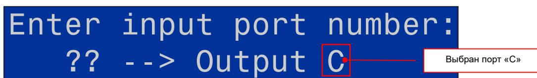
Нажатием кнопки «**1**», «**2**», «**3**», «**4**», «**5**», «**6**», «**7**», «**8**», выберите соответствующий номер входного порта, с нужным источником сигнала. Коммутатор произведет переключение, с отображением результата произведенной коммутации на жк-дисплее.
