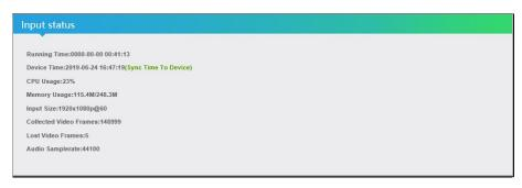
«Running Time» — Время, прошедшее с момента включение передатчика.
